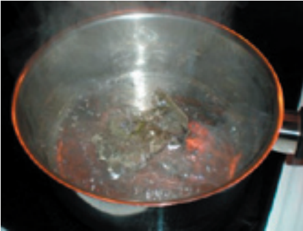
Bild 18. Förutom de mekaniska rengöringsmetoderna som trumling, smärgelduk, filar och stålull så kan man använda värmepistol, lut eller helt enkelt koka detaljerna i vatten på spisen.
