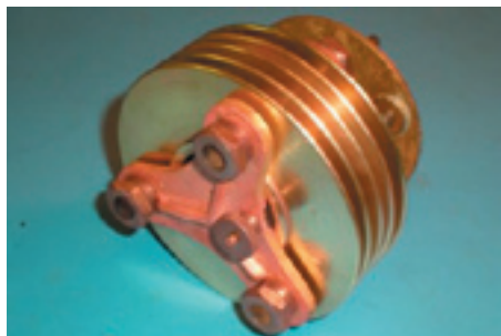
Bild 12. Den monterade gniststräckan är klar att funktionsprovas med hjälp av en variabel högspänningsgenerator.
