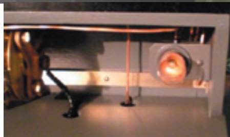
Bild 31. Lampan skall avge starkt sken vid full uteffekt 150 W vid normala driftförhållanden. Vid sändning på en stor antenn som p g a hög antennkapacitet orsakar hög antennström rekommenderades att skruva ur lampan för att undvika överhettning med glödtrådsavbrott som följd. Sådana handfasta tips förmedlas i de gamla böckerna från 1910- och 20-talen.
