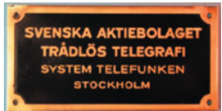
Bild 22. Skylten sprutades rakt över bokstäver och den omgivande kantlinjen. Då färgen härdat slipades förhöjningarna av med carborundum slippulver, kornstorlek 600, på en planskiva av glas.
