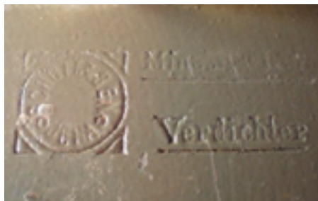
Bild 15. Tillverkarens stämplade logotyp såg vid första anblicken oläslig ut men med hjälp av släpljusteknik och digitalkamera blev texten läsbar. "Schott & Gen, Jena" står det i cirkeln och en sökning på Internet ledde direkt fram till fabriken som finns kvar än idag.
