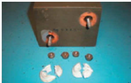
Bild 13. Kondensatorns märkvärde är 9930 cm vilket teoretiskt motsvarar 10400 pF. Uppmätt värde 10700 pF. De keramiska isolatorerna befanns vara spruckna på flera ställen. Bitarna limmades med Pro CA Superlim.
