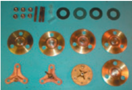
Bild 10. Delarna doppades i ett bad bestående av ljummet vatten och citronsyra. Därefter rengöring med mjuk borste i Grönsåpa. Noggrann avsköljning i rinnande vatten, torrblåsning och avtorkning med luddfri trasa.
