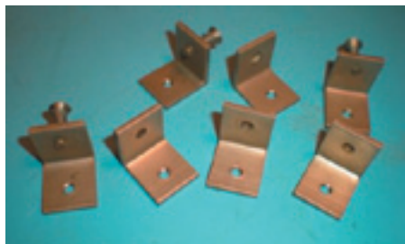
Bild 16. Utöver de elektriska komponenterna innehöll sändaren mekaniska fästelement, vinklar, skruv, brickor och muttrar. Smådetaljerna rengjordes i en roterande trumla där finkornig sand användes för att på mekanisk väg avlägsna rost och färgrester.
